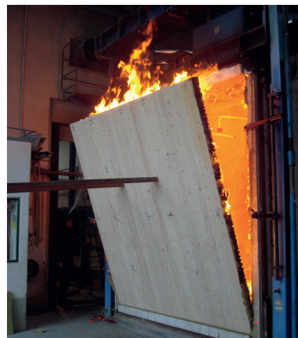
Spannender Moment nach 90 Minuten: Die 18 Zentimeter dicke Vollholzwand wird vom Ofen genommen.
